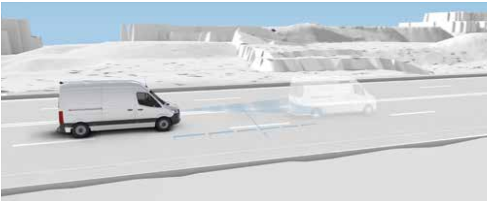
Der Aktive Abstands-Assistent DISTRONIC kann den vom Fahrer eingestellten Abstand zum vorausfahrenden Fahrzeug einhalten und entlastet ihn z. B. bei Autobahnfahrten oder im Stop-and-go-Verkehr.
