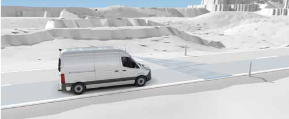
Der Aktive Spurhalte-Assistent kann helfen, ein unbeabsichtigtes Verlassen der Fahrspur zu erkennen, den Fahrer warnen und das Fahrzeug gegebenenfalls durch Bremsenriffe aktiv in die Spur zurückführen.
