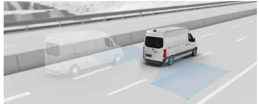
Der Totwinkel-Assistent mit Rear Cross Traffic Alert kann durch optische und akustische Warnsignale helfen, Unfälle beim Spurwechsel, beim Rückwärts-Ausparken und Aussteigen zu vermeiden.
