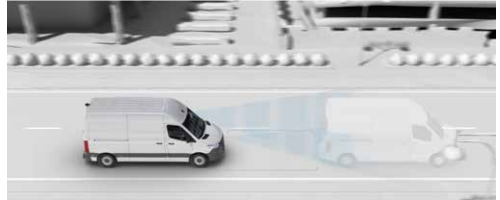
Der Aktive Brems-Assistent kann helfen, Unfälle mit vorausfahrenden Fahrzeugen und mit querenden Fußgängern zu verhindern bzw. die Unfallfolgen abzumildern.
